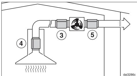
Чтобы шум работы вентилятора на кухне был минимальным, шумоподавитель должен быть расположен перед выносным вентилятором ③, как можно ближе к нему; при длинном воздуховоде - на штуцере воздуховода вытяжки ④. Если выносной вентилятор смонтирован в доме, то использование шумоподавителя сзади вентилятора ⑤ может уменьшить шум от его работы.
