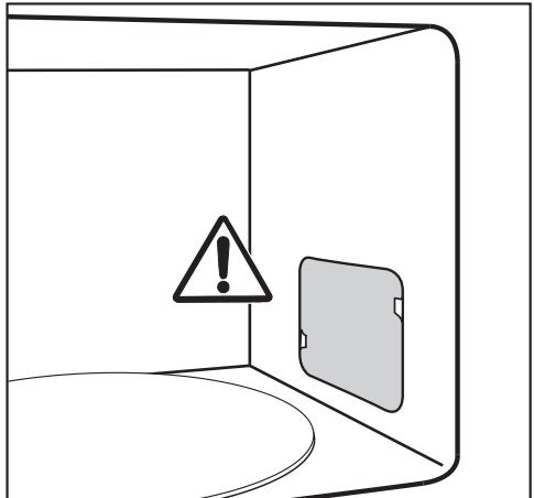
Не удаляйте специальную защитную пластины, расположенную в рабочей камере перед отверстием выхода микроволн, а также плёнку с внутренней стороны дверцы.
