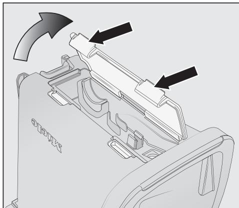
■ Нажмите обе кнопки разблокировки на нижней стороне настенного крепления и снимите крышку кабельной коробки.
