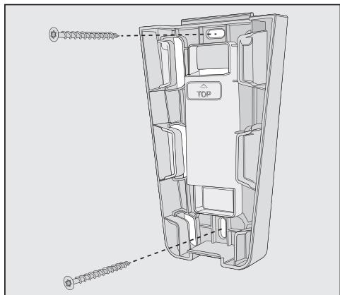
■ Закрепите монтажную пластину на стене.
